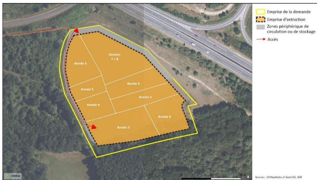
Figure 6 : Phasage de remblaiement (source : ARTIFEX, 2023)
