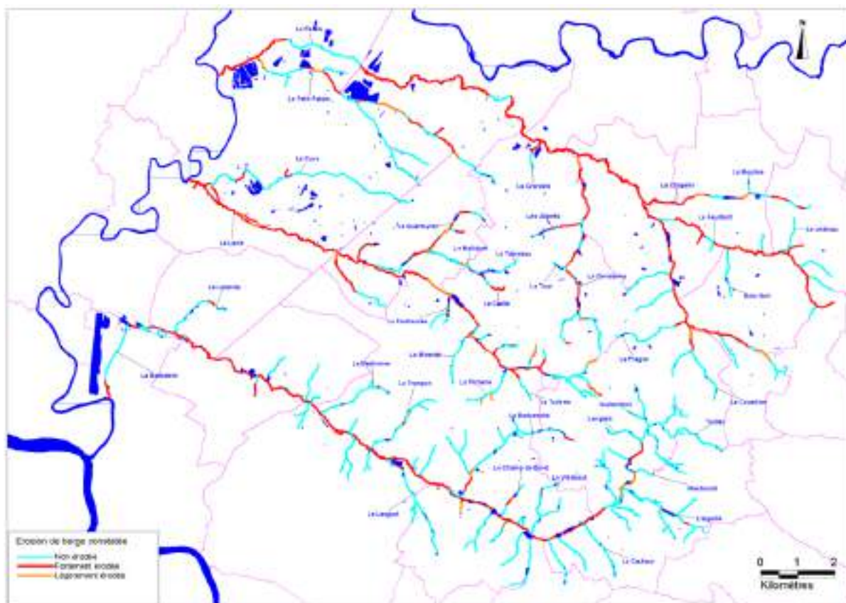
Erosion des berges sur les bassins versant de le Barbanne, du Lavié et du Palais (source : Plan Pluriannuel de Gestion des bassins de la Barbanne, du Lavié et du Palais / Rapport de phase 1)
