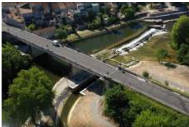
Figure 37 : Rivière de contournement du seuil sur la Dronne à Coutras, vue aérienne
