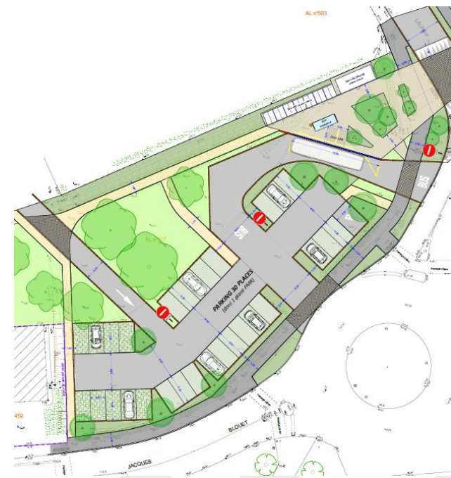
Exemple de schéma d'aménagement d'une aire multimodale source : Mairie de Guichen Pont-Réan
